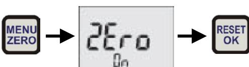
Die Nullpunktkorrektur ist durchgeführt. Im Display erscheint 0.0 bar als IST-Wert. Der Abgleich bleibt aktiviert, bis das Gerät ausgeschaltet wird.
