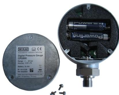
Öffnen Sie das Batteriefach. Setzen Sie die neuen Batterien gemäß Abbildung ein. Achten Sie auf die Polarität der Batterie.
